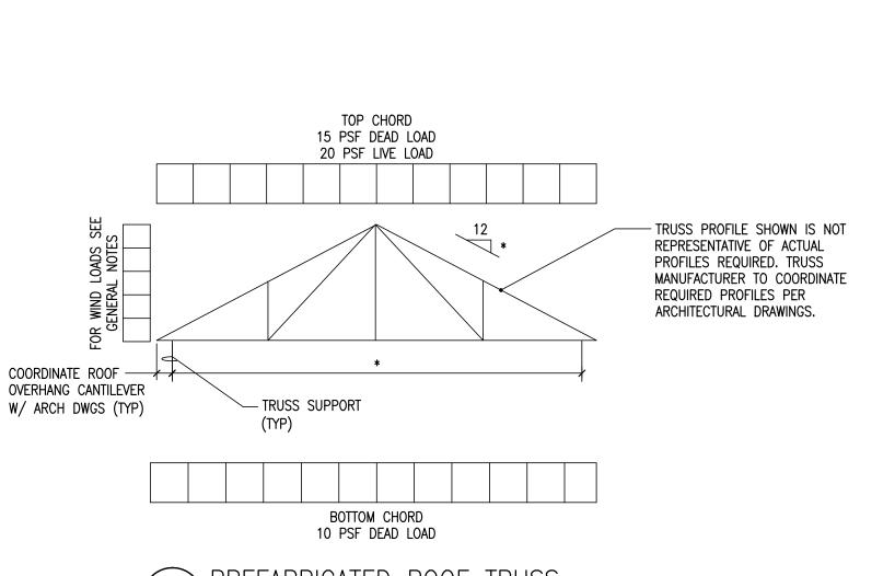
1 PREFABRICATED ROOF TRUSS
