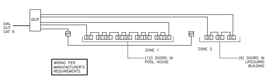
(3) INTRUSION SECURITY SYSTEM DIAGRAM
